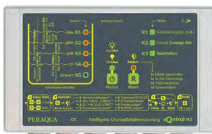
Die Mikroprozessor-Schwallwassersteuerung beinhaltet intelligente Funktionen wie Sondenüberwachung, Füllzeitüberwachung und Stromsparfunktion für die Filterpumpe. Alle Ausgänge sind potentialfreie Umschaltkontakte und daher für jede Poolsteuerung geeignet.
