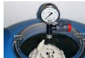
Optional, Entlüftung mit Praher S4 Laborkugelhahn
